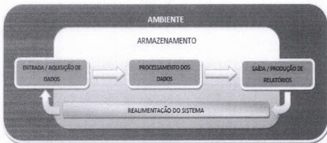
Figura 52 - Estrutura de sistema de informação
